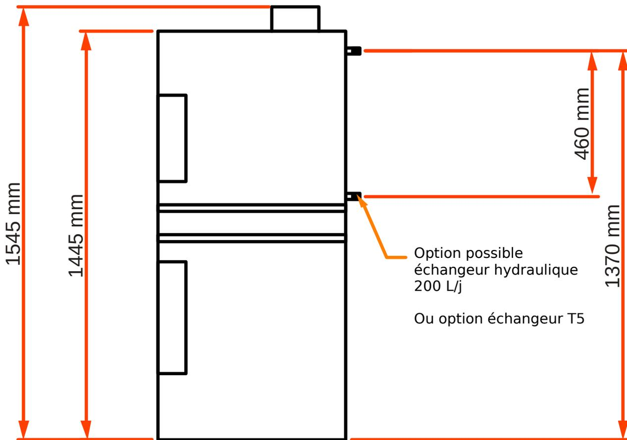
Entrée / sortie échangeur d'eau
