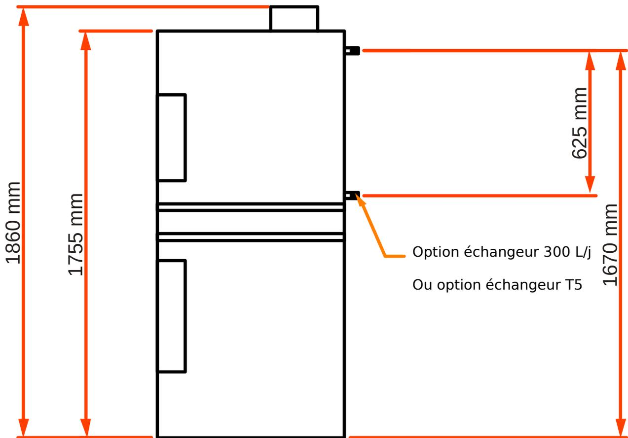
Entrée / sortie échangeur d'eau
